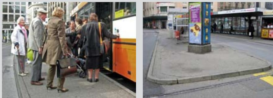
Sur la photo de gauche, la largeur de l'arrêt situé sur l'îlot est à peine suffisante pour permettre un croisement confortable des piétons. Sur la photo de droite, la marche limite l'accès à l'arrêt.
