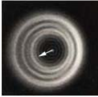
Figure 35 - exemple de décollimation et réglages correctifs associés
