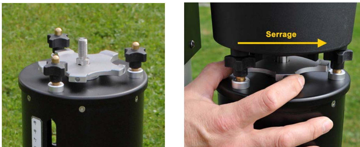
Figure 8 - serrage de la monture sur les tétons de réglage
