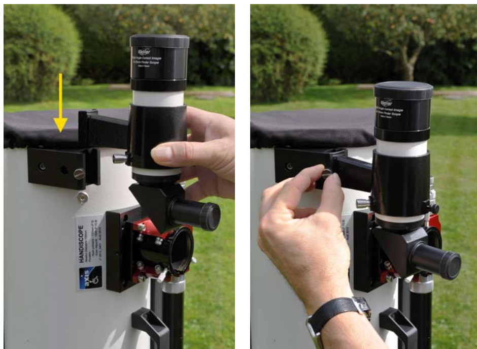
Figure 17 - mise en place du chercheur
