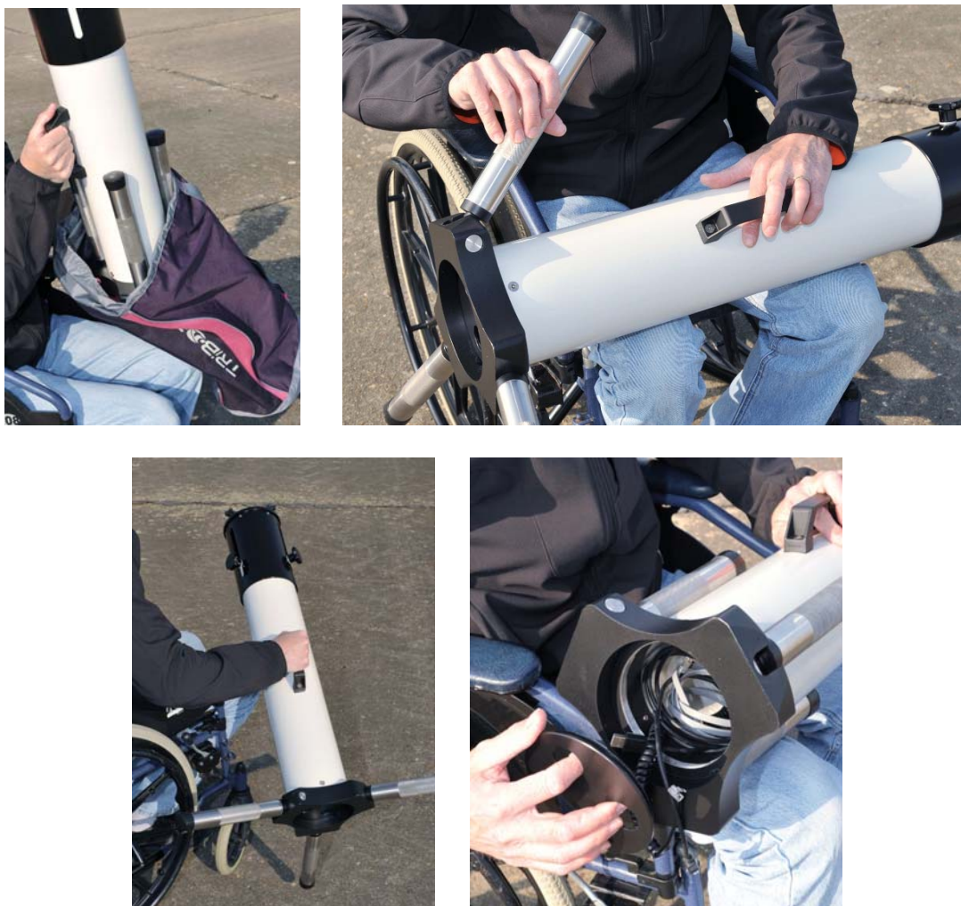
Figure 5 - mise en place du pied colonne
