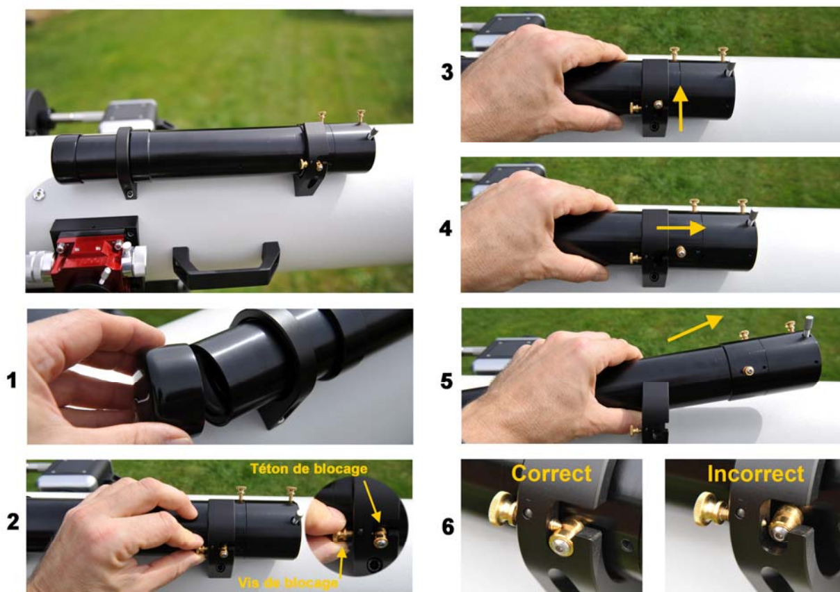
Figure 18 - dépose du train optique de son système de rangement
