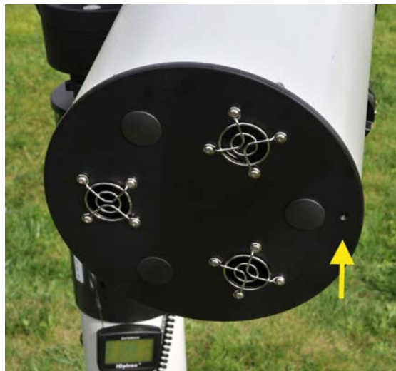
Figure 30 – Repère sur le dos du barillet primaire
