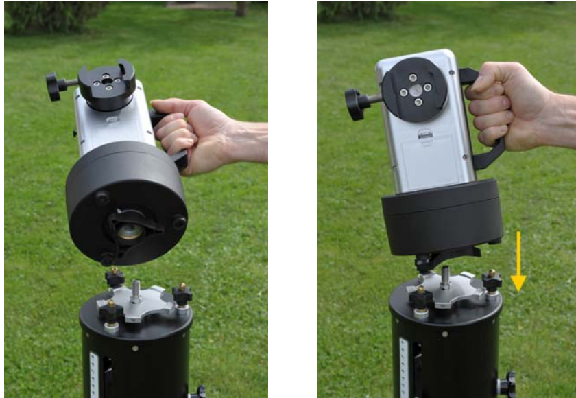
Figure 6 - mise en place de la monture sur les tétons de réglage de niveau
