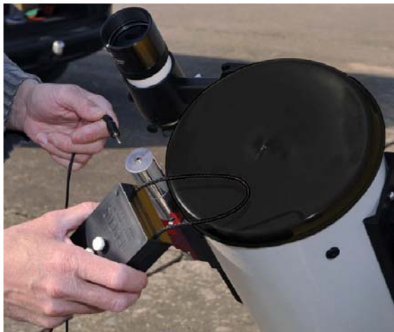
Figure 25 - branchement du boîtier électronique de focalisation (option 2)
