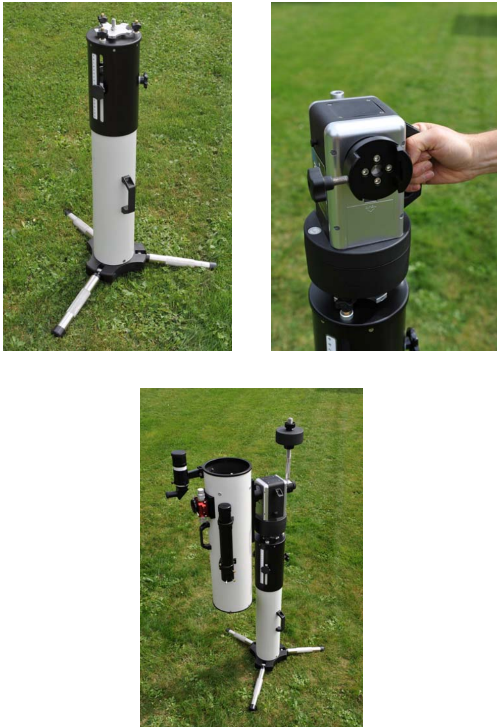
Figure 4 - les trois étapes de montage
