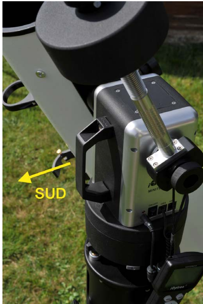
Figure 27 - orientation de la monture vers le Sud avant le premier pointage
