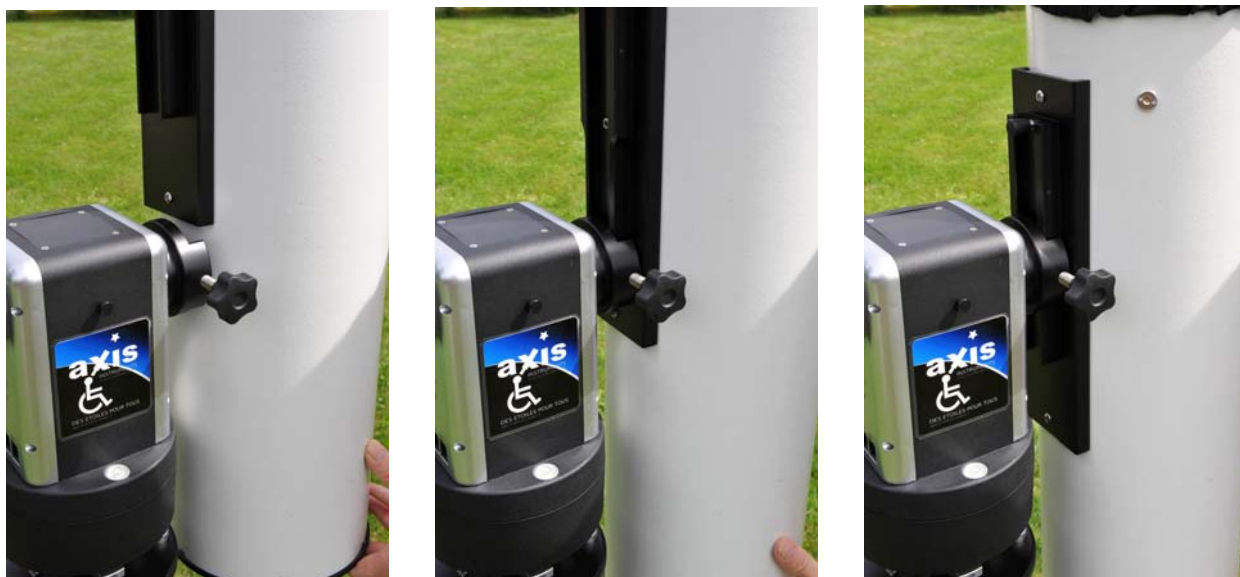
Figure 15 - mise en place du tube à l'aide de la queue d'aronde
