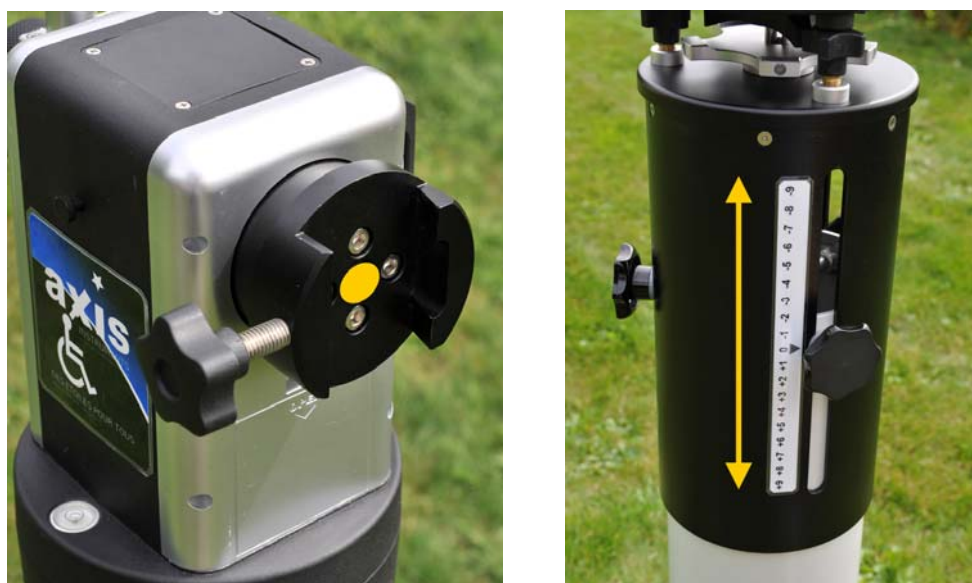
Figure 11 - réglage du niveau d'observation à l'oculaire
