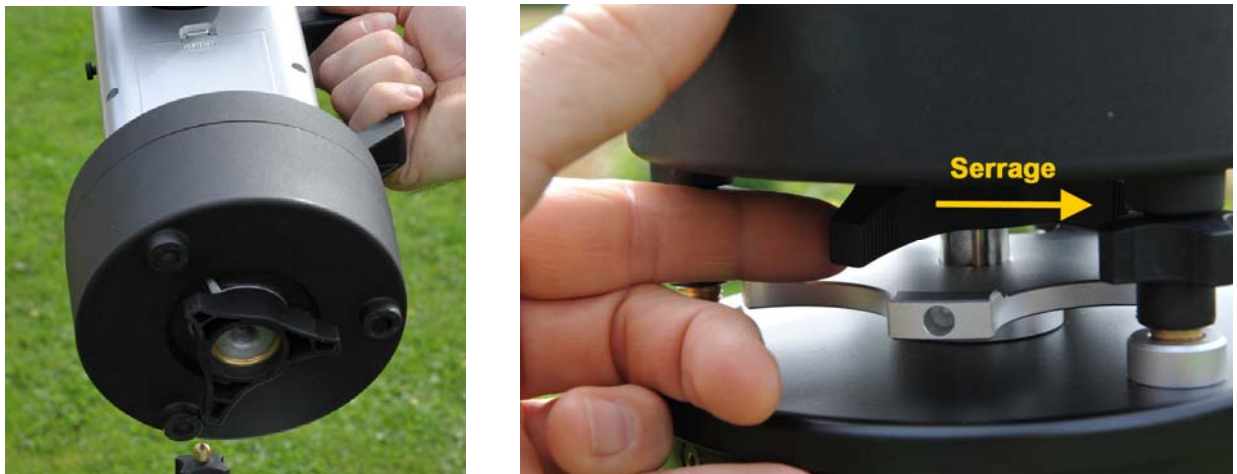
Figure 9 – écrou de blocage de la friction de l'axe d'azimut de la monture
