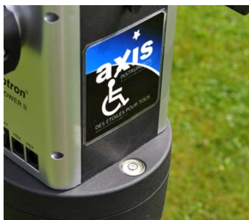
Figure 7 - niveau à bulle de la monture
