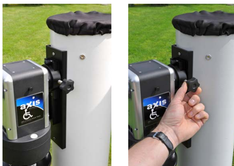
Figure 16 - blocage de la queue d'aronde du tube optique
