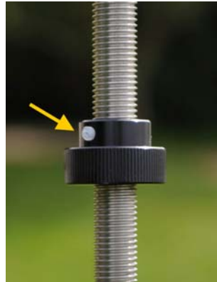
Figure 22 – vis de blocage de la butée inférieure du contrepoids
