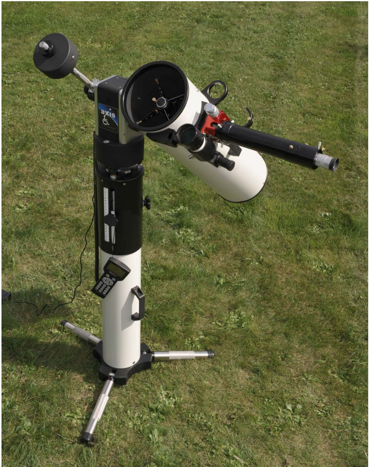
Figure 26 - le Handiscope prêt pour l'observation (version porte-oculaires démultiplié)
