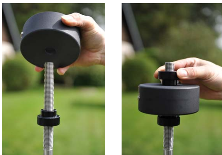
Figure 21 - mise en place du contrepoids
