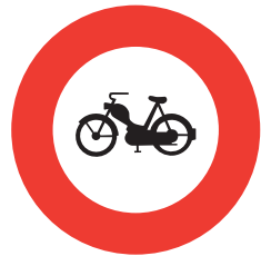
2.06 Circulation interdite aux cyclomoteurs (art. 19)
